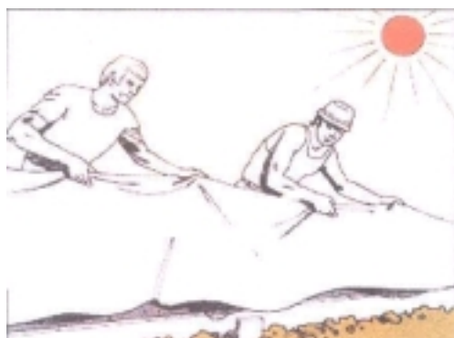
Rys 2. Zabezpieczenie powierzchni świeżego betonu poprzez przykrycie materiałami z tworzyw sztucznych
